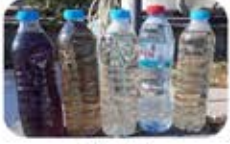
Atıksu Giriş + MBR + RO
